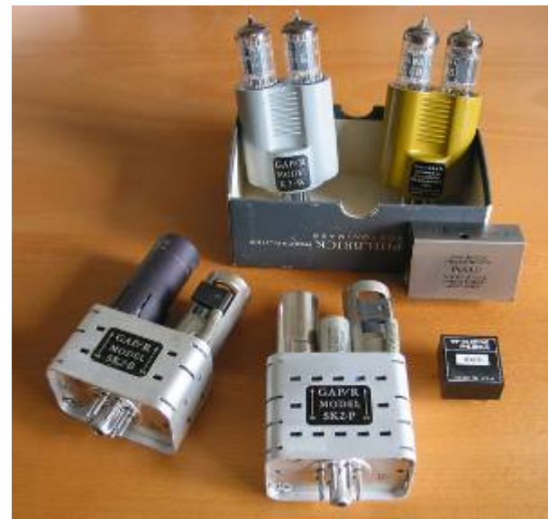
Historiske OpAmps fra Philbrick Bygget opp av "radiatorer" – hvert "rør" inneholder 2 forsterkere (2 stk. trioder)
