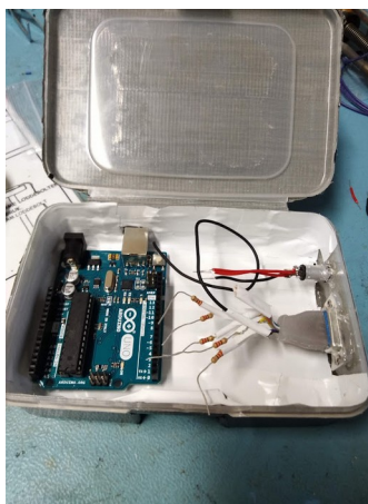
Figur 5: Her har en 3.5 mm jack (AUX) hunn samt en VGA hunn presset inn i hullene på boksen.
