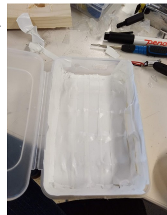
Figur 3: Her har boksen fått et beskyttende underlag av hvit EL-teip.
