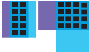
Figure 4.34: Mange viakontakter for å redusere motstand. (FIG4.33)
