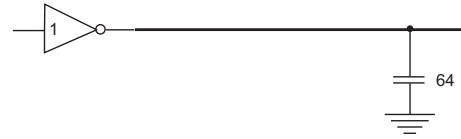
Figure 4.25: Ekstern last som skal drives av et antall invertere. (FIG4.21)
