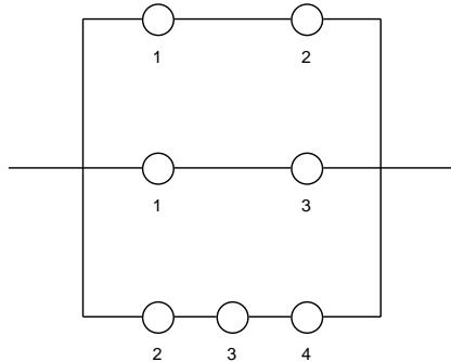
Vi skal i denne oppgaven se på et binaert monotont system  $(C, \phi)$ . Systemet er vist i blokkskjemaet i figuren over. Systemets komponentmengde er  $C = \{1, 2, 3, 4\}$ . Vi lar  $\mathbf{X} = (X_1, X_2, X_3, X_4)$  betegne vektoren av
