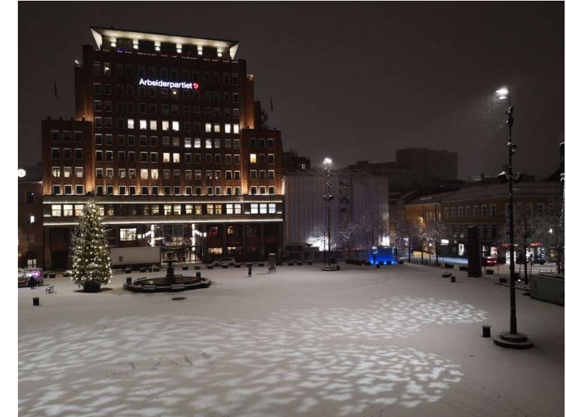
Figur 77 Eksempel på belysning fra høye master med effektbelysning, områdebelysning og fasadebelysning rundt plass
