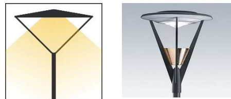
Figur 22 T.V.: Lysfordeling parkarmatur (Type D) T.H.: Eksempel Philips Avenue. Armaturer til parkbelysning
