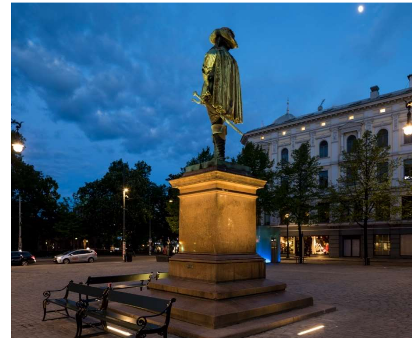
Figur 27 Eksempel på belysning av skulptur, sokkel belyst med nedgravingsarmaturer (opplys), selve skulptur belyst med spot fra mast
