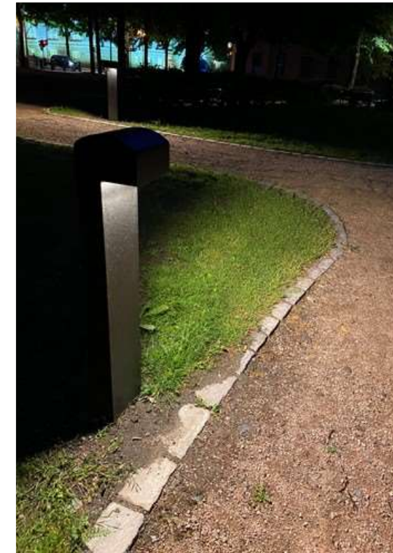
Figur 93 Eksempel på en godt avskjermet pullert med god lysfordeling
